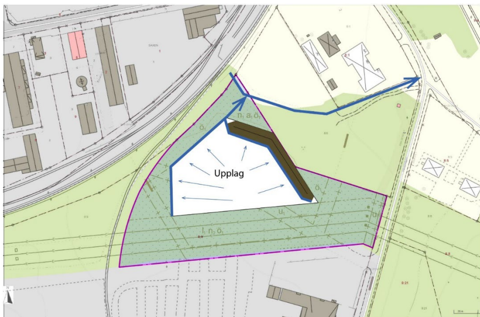
Figur 5. Skiss över dagvattenhanteringen och avskärmande vall mot nordöst. Större blå pilar symboliserar dagvattendiken och dess flödesriktning medan mindre blå pilar symboliserar ytavrinning från upplagsytan.
