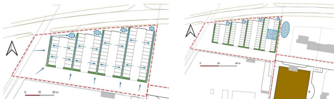
Figur 21 Bild till vänster: principskiss över föreslagen avvattning av parkeringsplatsen. Bild till höger: ytbehov för alternativen damm i öst respektive kassettmagasin under mark. Källa: Melica.
