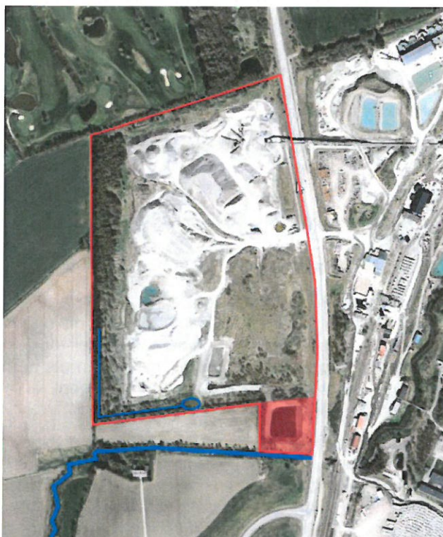
Figur 2. Befintligt dike samt utloppsbygg är markerad med blått inom fastigheten. Söder om fastigheten finns ett större dike dit områdets dagvatten leds.
