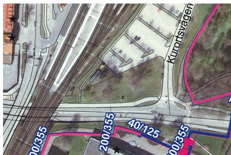
Befintlig fjärrvärmedragning söder och öster om planområdet.
