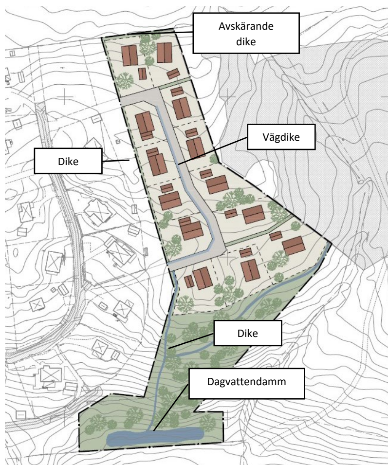
Schematisk redovisning av föreslagen dagvattenhantering. Vattnet leds bort eller samlas upp i diken och leds via trummor och ett krossdike till en dagvattendamm i söder.
