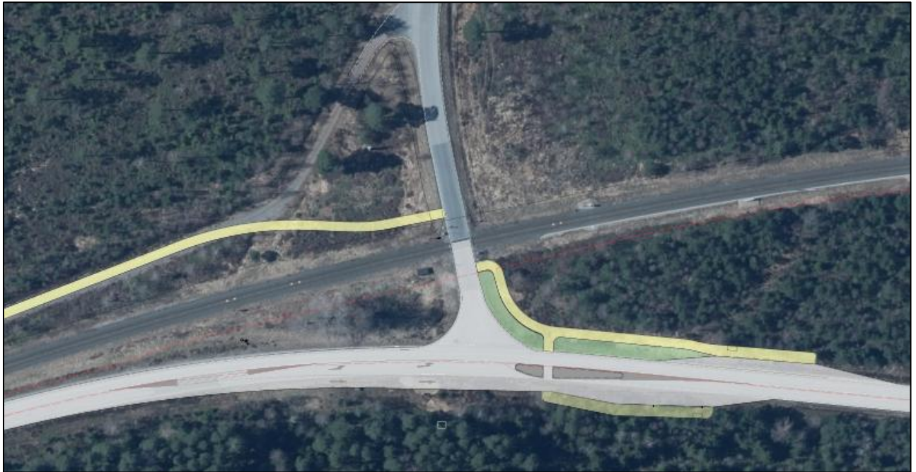
Förslag på åtgärder vid plankorsning från trafikutredning.
