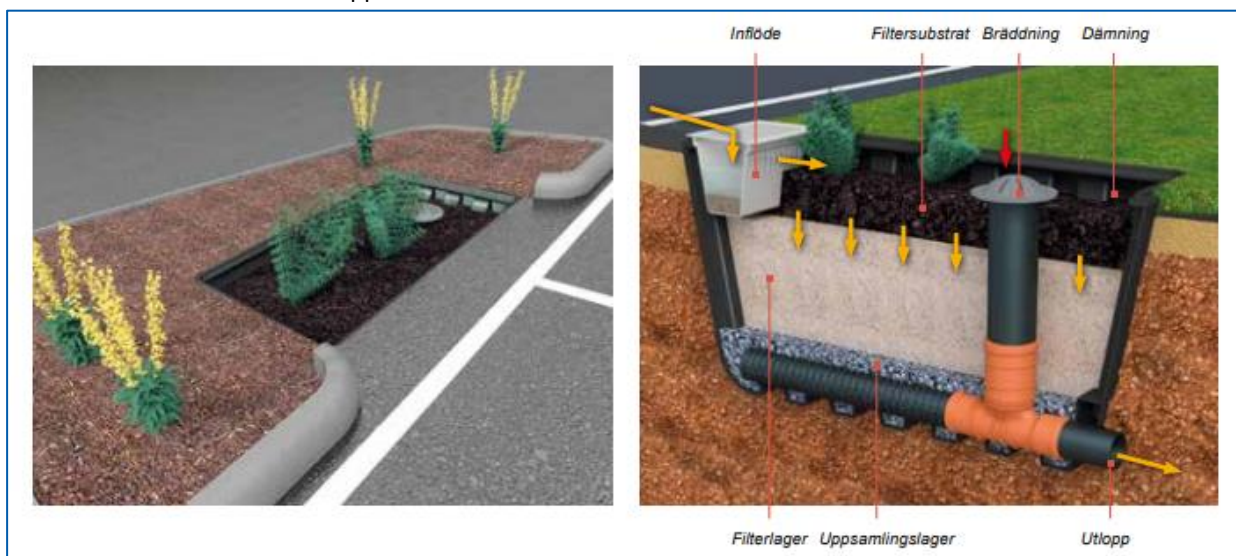
Figur 13. Principlösning för regnbäddar av Uponor
