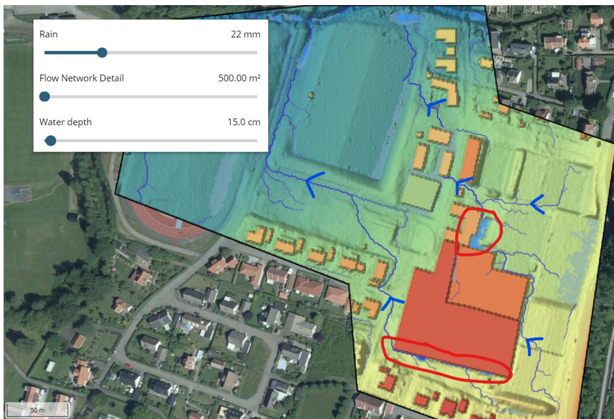
Figur 10. Lågpunkter och ytliga rinnvägar inom planområdet enligt planförslag med editerade markhöjder för utbyggnad och potentiell dagvattenhantering.
