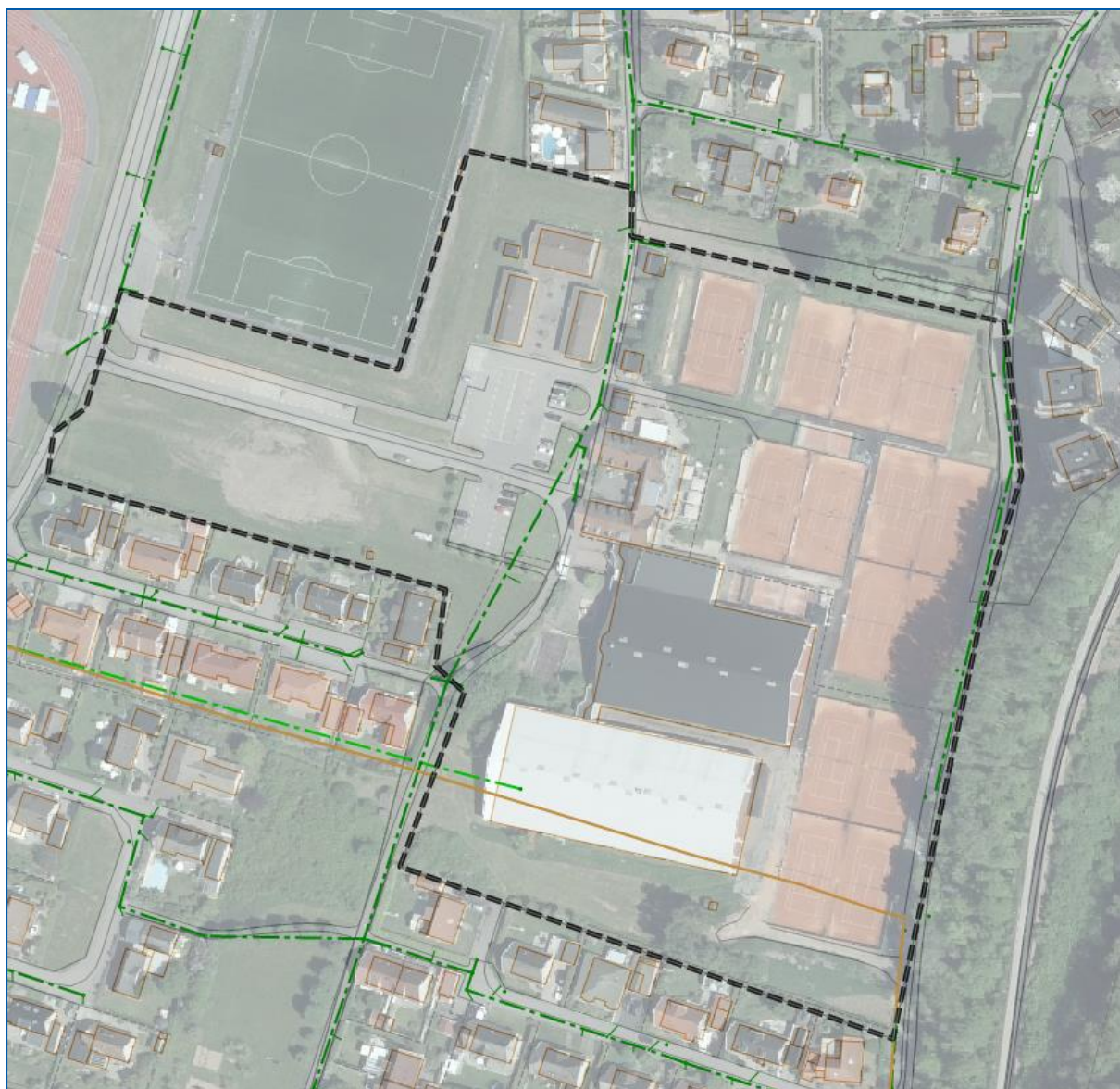
Figur 5. Dagvattenledningar inom och i anslutning till planområdet. Planområde inringat i svart streckad linje. Utlopp i Örebäcken i norr. Ljusgrön linje visar dikningsföretagets ledningar inom planområdet.
