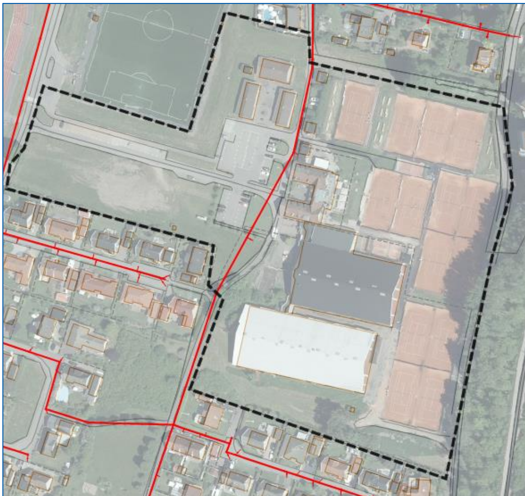
Figur4. Spillvattenledningar inom och i anslutning till planområdet.
