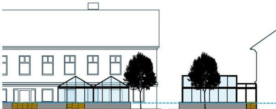
Illustration som visar förslag till översvämningsskydd med naturstensmur. Utklipp från Gestaltungsprogrammet. Källa och montage: Vänersborgs kommun
