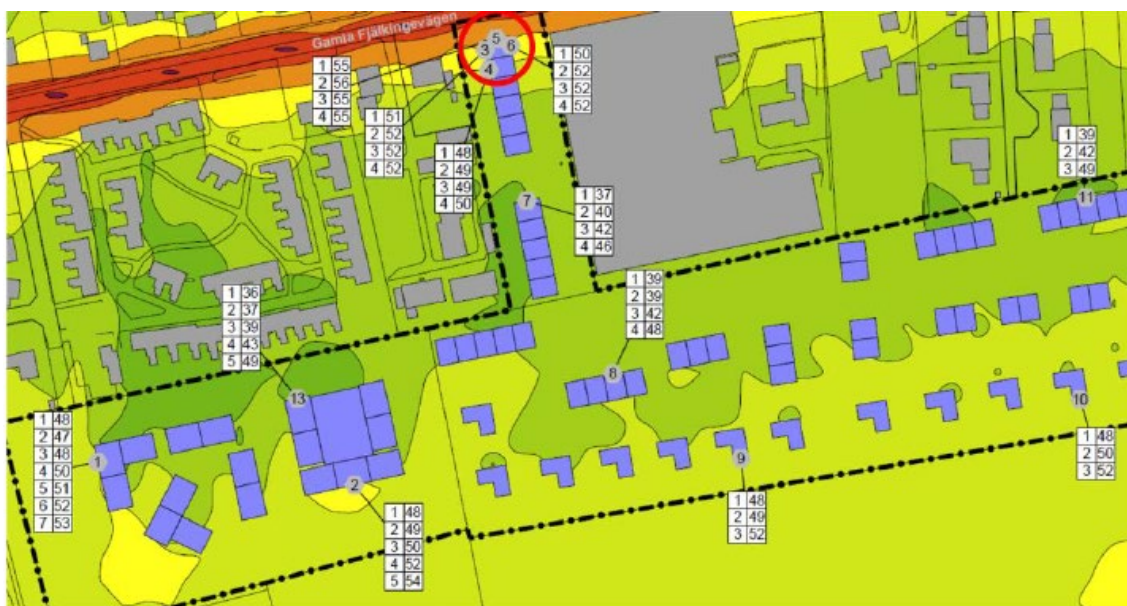
Överskridande av riktvärde för uteplats. Trafik- och bullerutredning Östra Hammar, Ramböll 2020-07-02
