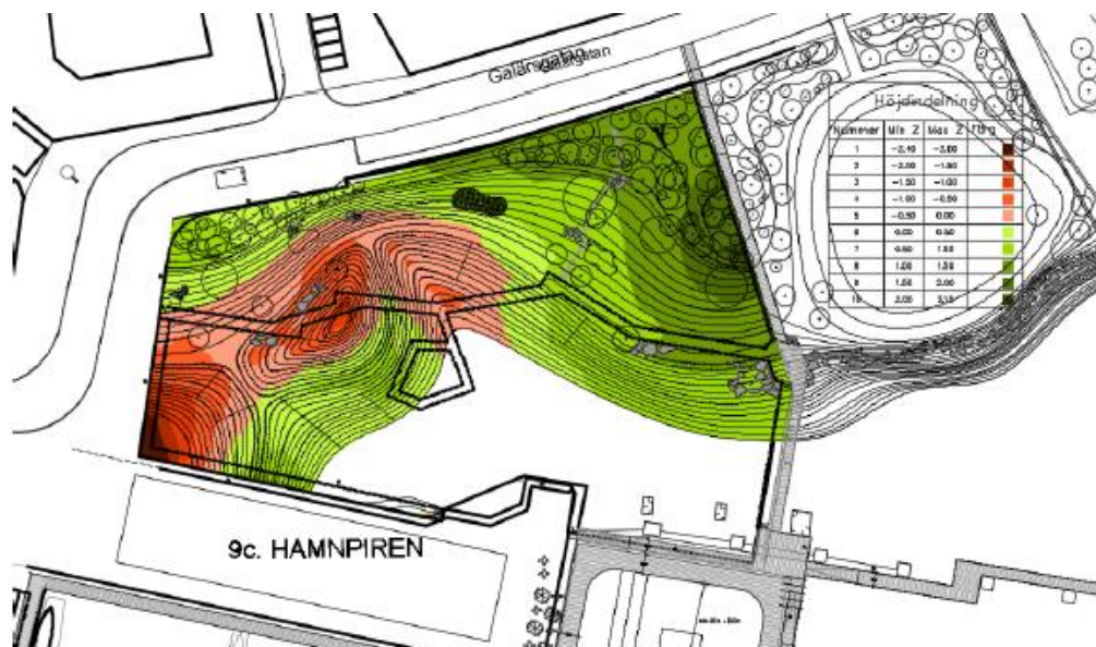
Figur 16. Dagvattenparkens planerade muddring och utfyllnad. Negativa siffror (röd färgskala) indikerar muddring och positiva siffror indikerar utfyllnad (grön färgskala). Siffrorna representerar skillnad i marknivå jämfört med idag. Inom det vita området sker ingen förändring mot nuvarande förhållanden. Bild från Teknisk beskrivning (tillståndsansökans Bilaga A).
