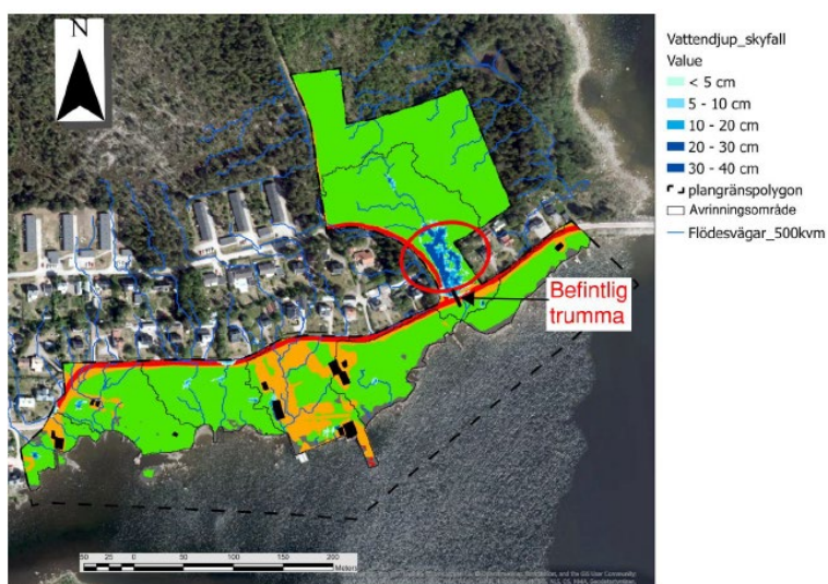
Figur 33. Resultat från modellering vid ett 100 års regn med varaktighet 6h och klimatafaktor 1.3 i enlighet med befintliga förhållanden i området (Sigma Civil, 2025).
