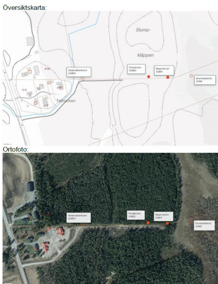
Figur 26. Etablerade brunnar för propumpning och observation.
