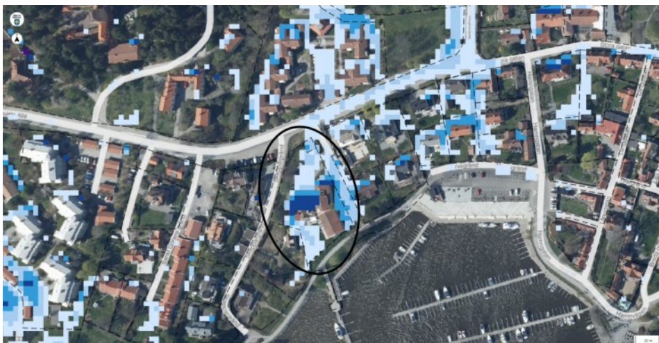
Beräknade maximala vattendjup (m) för ett 100 års regn med klimatkfaktor 1,25.
