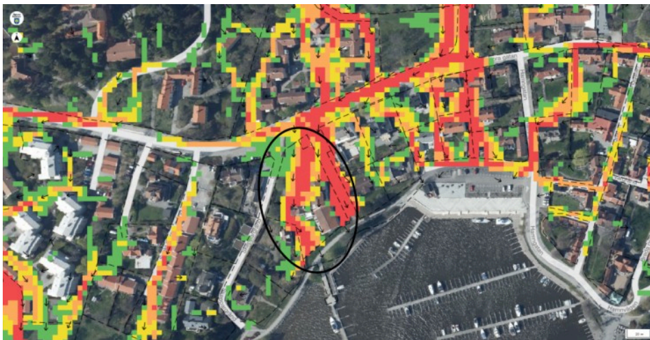
Beräknade maximala flöden (m³/m/s) i samband med ett 100-årsregn med klimatkfaktor 1,25. Pilarna visar riktningen som vattenflödena tar.
