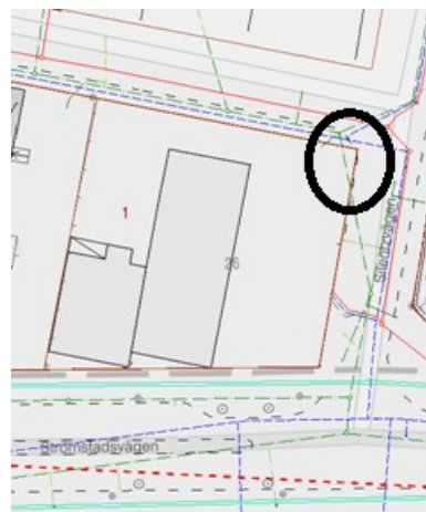
Figur 7. Befintlig dagvattenledning är inringad.
