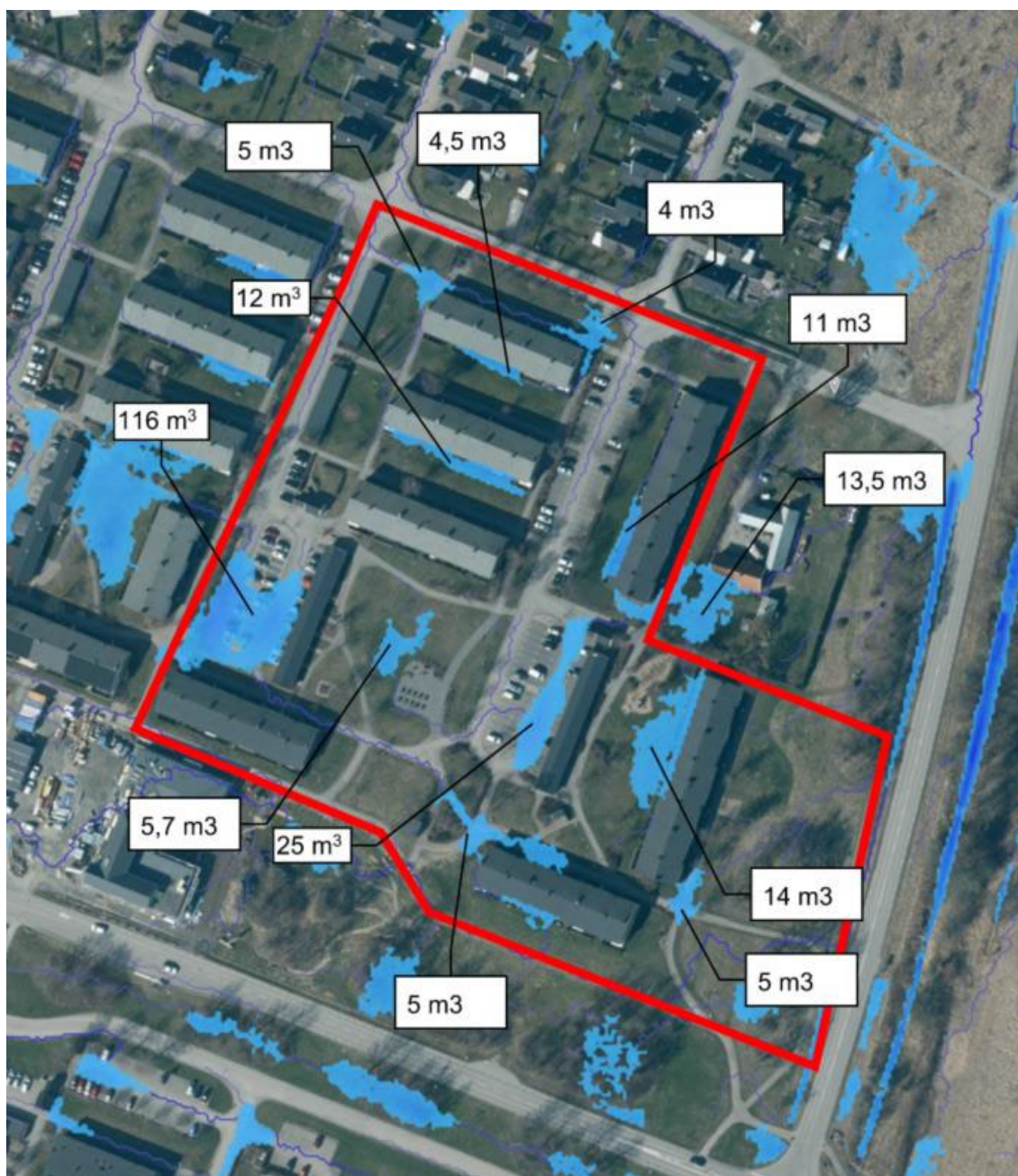
Bild 17. Skyfallsanalys (SCALGO Live, 2022) hämtad ur VA-utredning (AFRY, 2024-02-23). Observera att den röda linjen inte anger plangränsen utan enbart den del av fastigheten Bua 1:49 som ingår i planförslaget.
