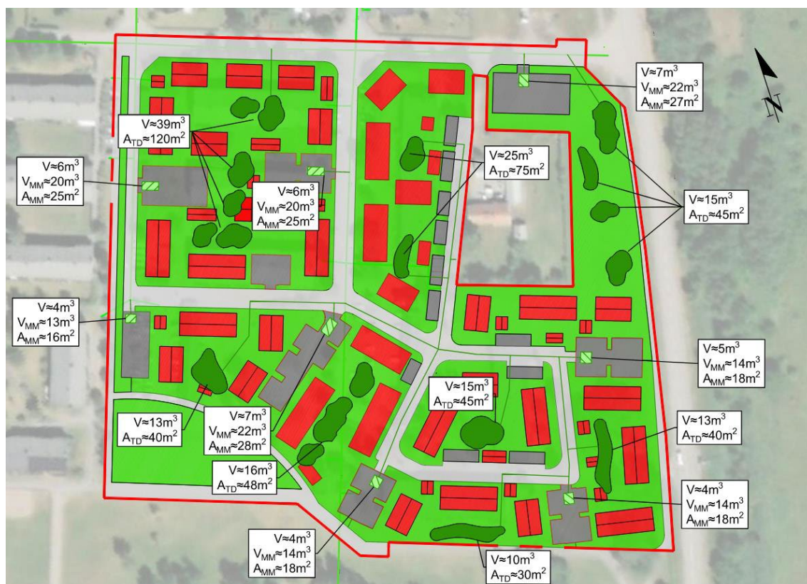
Bild 7. Förslag till dagvattenhantering genom torrdammar (mörkgrön symbol) och underjordiska magasin (ljusgrön skrafferad symbol) på kvartersmark. Bild ur VA-utredning.
