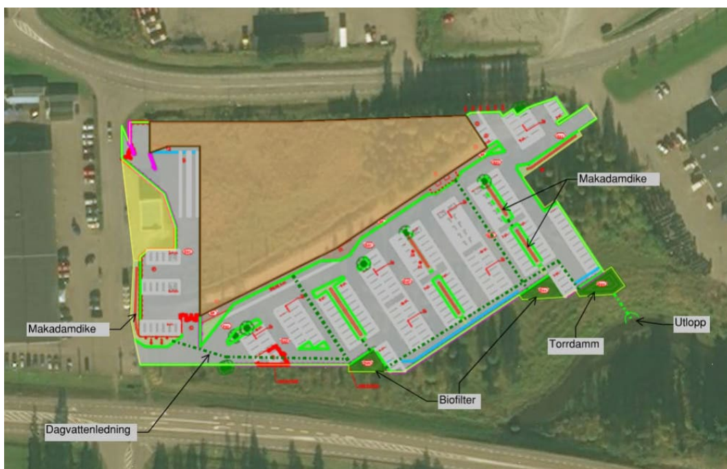
Bild 11: Övergripande systemlösning för omhändertagande av dagvatten.
