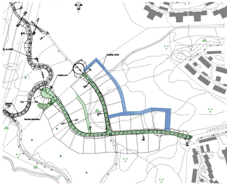
Figuren visar en översikt på funktion för respektive dike. Grönt = Dagvatten, Blått = Markavvattning (avskärande).
