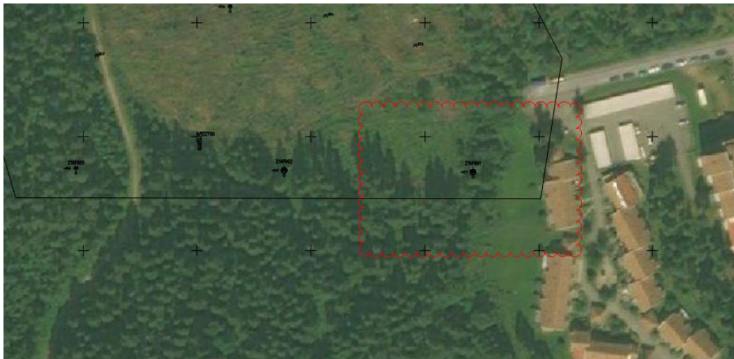
Borrpunkt där finsediment i form av lera och silt har påträffats vid sondering.
