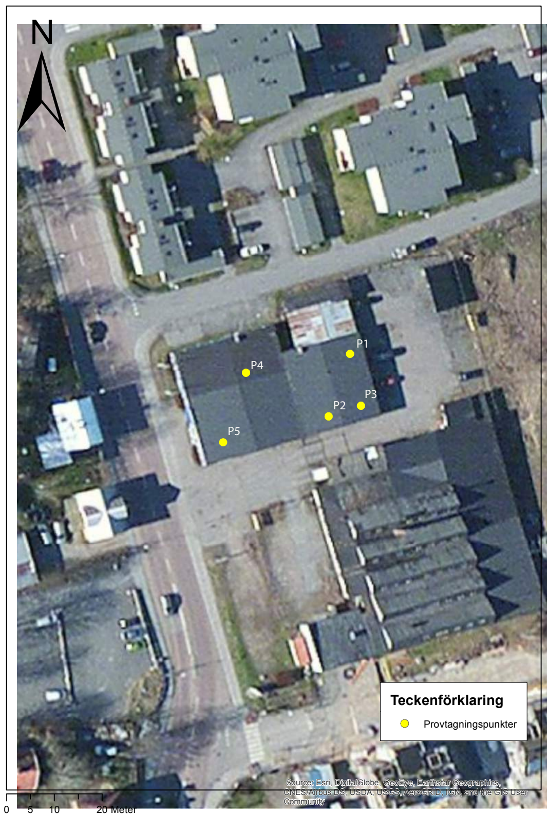
Figur 2: Bild på provtagningspunkter vid utförd miljöteknisk undersökning 2018-10-16. Dessa punkter är inte exakta på grund av att GPS ej har mottagning inom befintlig byggnad.
