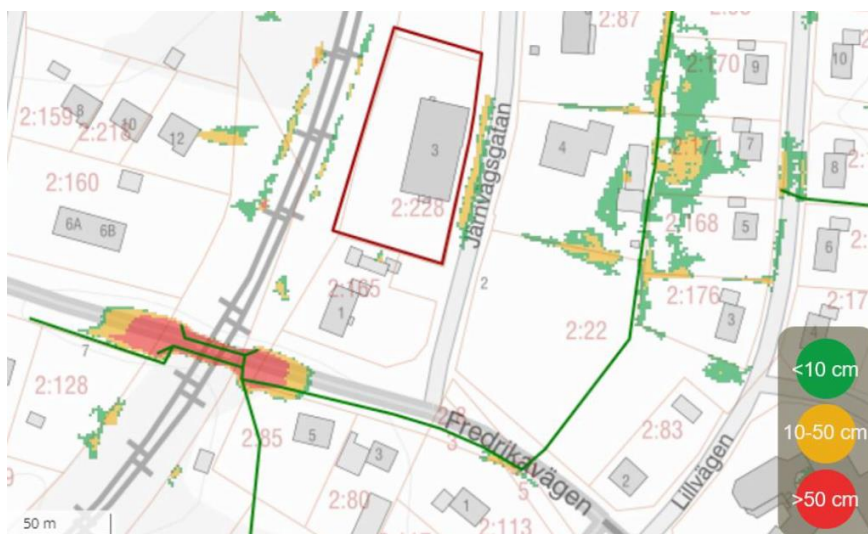
Figur 10. Lågpunkter med risk för stående vatten vid ett regn med 10 års återkomsttid, utan klimatfaktor. Bakgrundskarta: Lantmäteriet (2022), Scalgo (2022).
