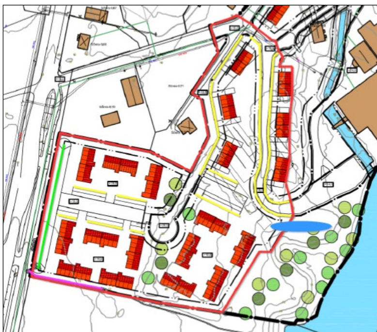
Figur 39: Förslag på dagvattenhantering för nytt bebyggelseområde 2 och 3 enligt dagvattenutredningen. Rosa linje är avskärningsdike, gul linje är krossdike, grön linje är fördröjningsdike och blå cirkel är dagvattendamm. OBS figuren är från samrådsförslaget vilket medför att avvikelser i förslaget kan förekomma. Dagvattensituationen bedöms dock likvärdig.
