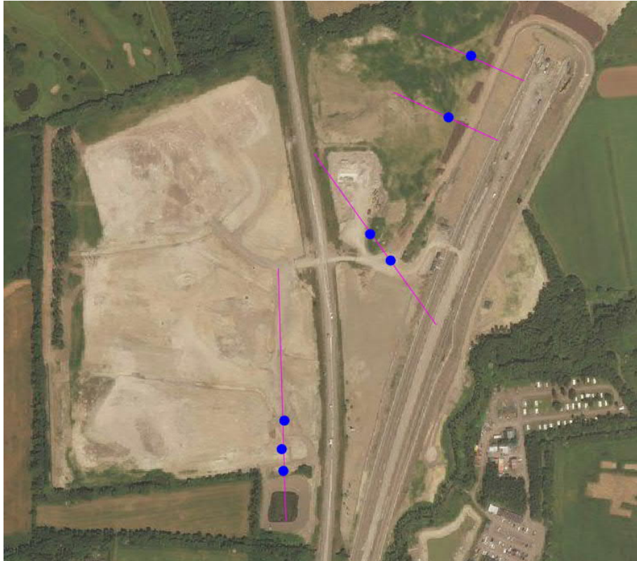
Figur 3: Ungefärlig placering av borrpunkter (i blått) och tänkta sektioner (i lila).
