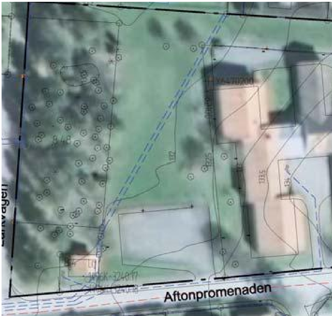
Befintlig 0,4 kV-kabel i planområdet, blå streckad linje.
