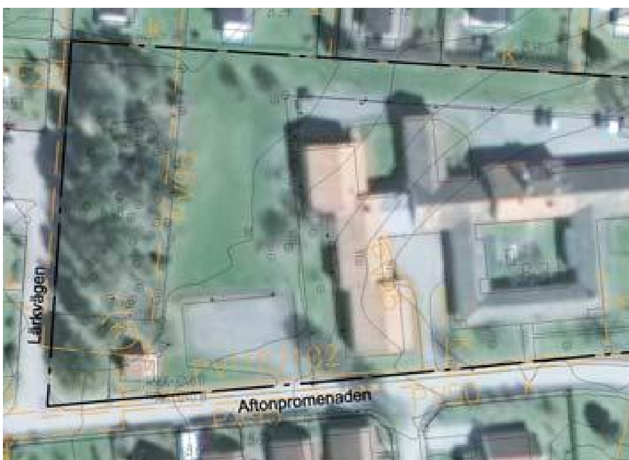
Befintliga teleledningar i planområdet, orange linje.
