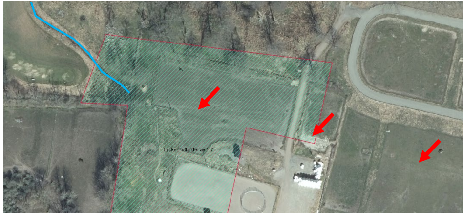
Bild 26. Norra delen har ett öppet dike (blå linje) som rinner in planområdet som sedan är kuverterad under hagmark, röd pil visar dess läge.
