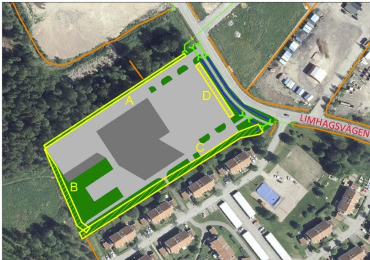
Fig 7. Illustrerade platsbehov för diken. Lämpliga mått anges i dagvattenutredningen. Kvartersmarkens disposition enligt tidig skiss i planprocessen (Mavacon).
