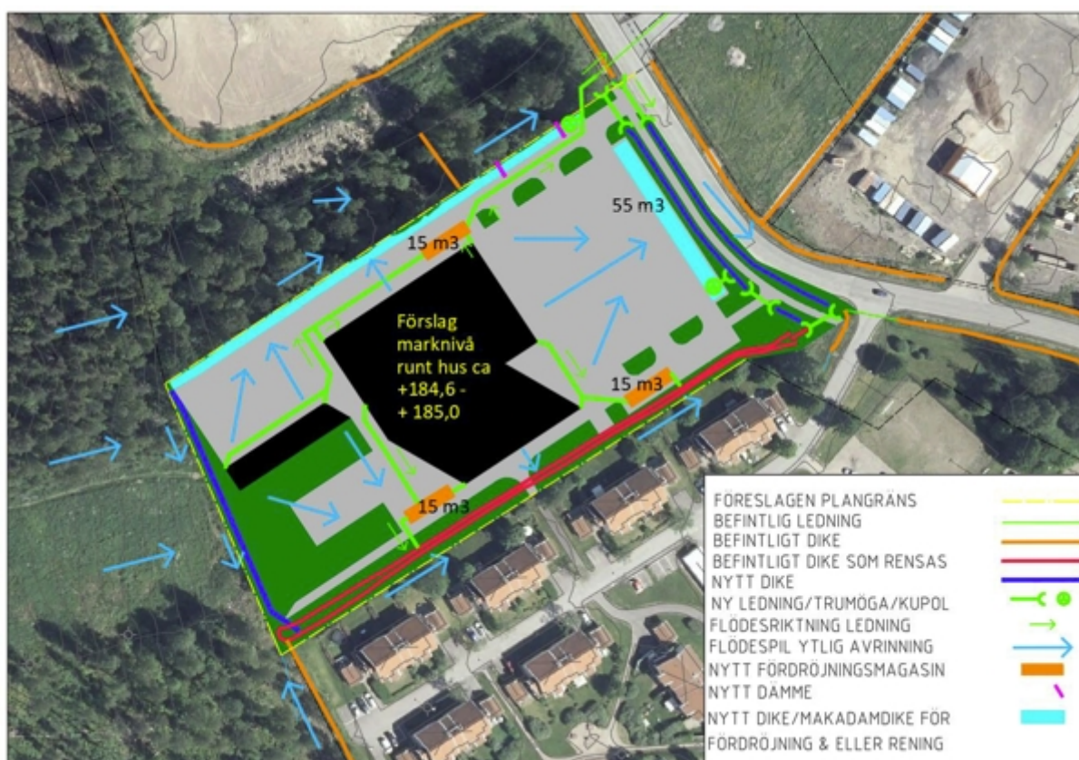
Fig 8. Föreslagen systemlösning. Kvartersmarkens disposition enligt tidig skiss i planprocessen (Mavacon).
