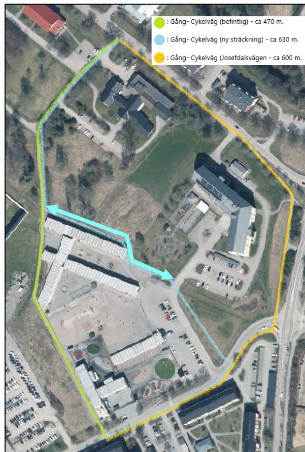
Figur 36: Längd avseende befintlig och alternativ till GC. Röd streckad linje avser ny GC till äldreboendet samt övergångsställe till befintlig GC på andra sidan Johannesbergsgatan. Pil visar möjligheten att sammankoppla GC-nätet i framtiden om behov uppstår.
