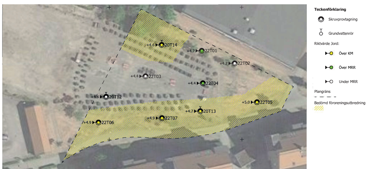
Provtagningsplan för Sockerbruksparken. Bilden visar inom vilka områden som det finns konstaterade markföroreningar
