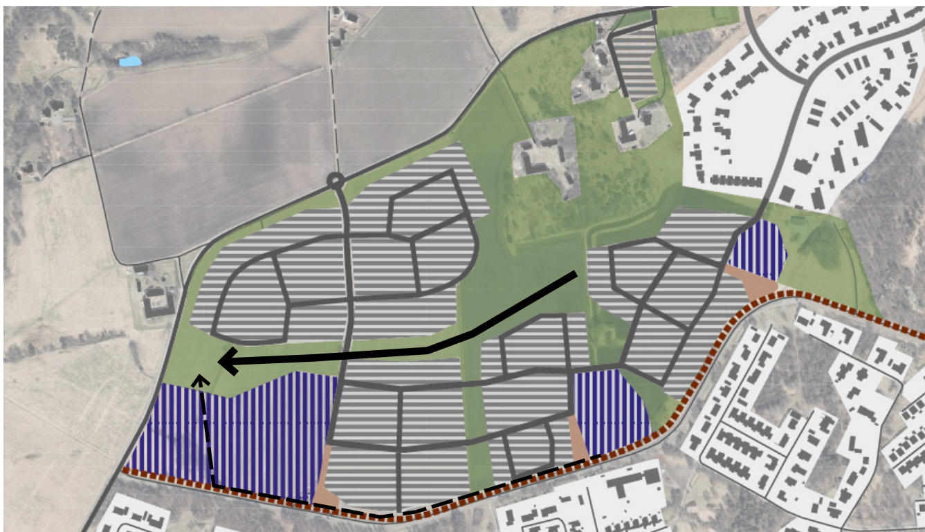
Karta som visar dagvattenstråket (svart pil) samt diket som ska leda ut vatten vid kraftiga skyfall (streckad svart pil).
