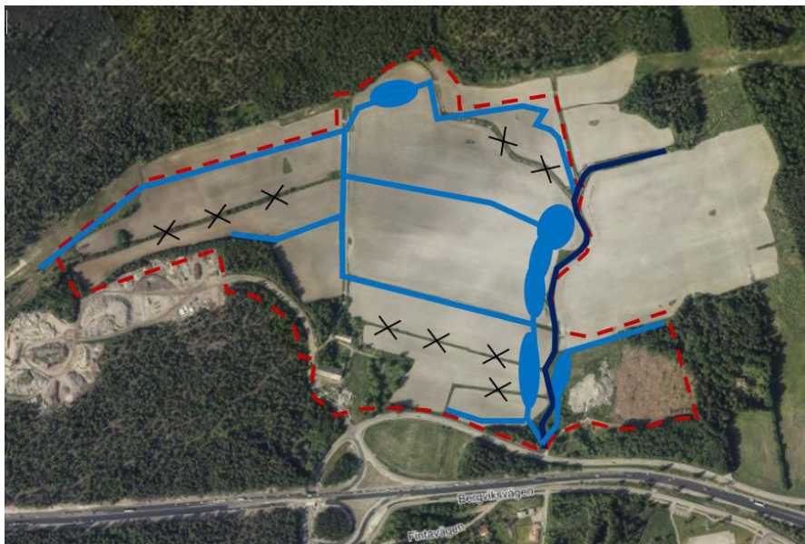
Schematisk skiss av dagvattenanläggningen. Mörkblå = Eriksbergsbäcken, ljusblå = diken och dagvattendammar, överkorsad linje = igenlagda diken, röd streckad linje visar plangränsen.
