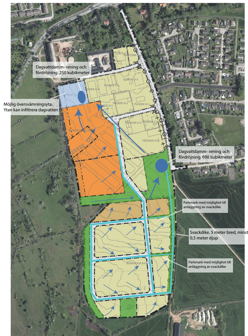
Bild 32. Karta som visar dagvattnets flödesriktning inom planområdet. Ljusblå markering visar fördröjningsmagasin i form av svackdiken och skelettjord. Dessa ingår i gaturum samt inom parkmark. Grönområden är markerade med grönt.
