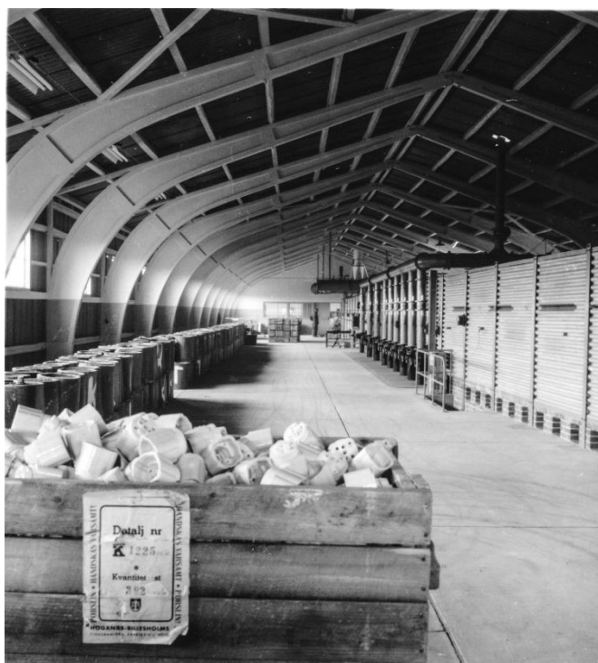
Foto taget inne i den då nya tillbyggnaden (trädelen). Till höger i bilden syns tunnelugnen, som var ungefär 60 meter lång (vilket är kort för att vara en tunnelugn). Foto från Stanfordska Sällskapet.
