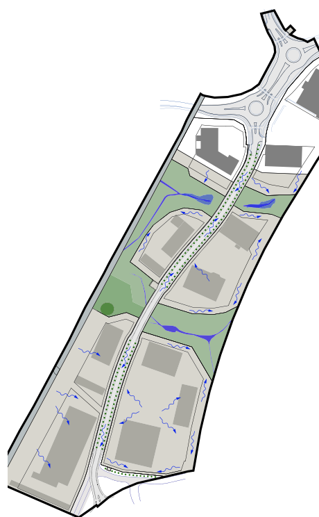
Tänkt dagvattenhantering. Pilarna visar vattnets väg.
