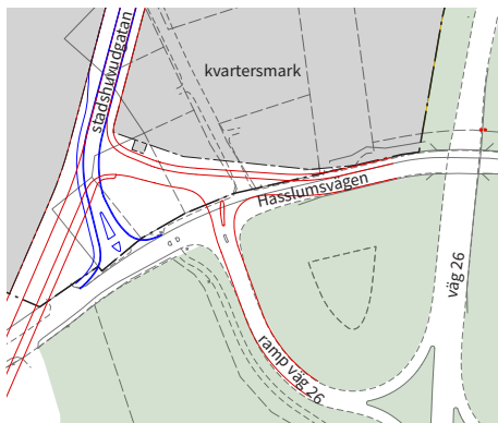
Förslag till trafiklösning vid Hasslumsvägen. Befintliga vägar streckade i grått, tillfällig anslutning i blått och framtida väg i rött.
