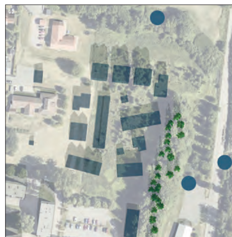
När dagvattnet har renats och fördröjts släpps det ut i någon av de tre utsläppspunkterna (blå)
