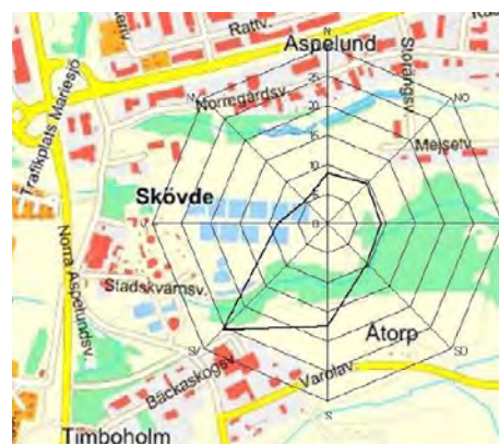
Vindros som illustrerar de vindriktningar och vindhastigheter som oftast råder på en given plats (ur MKB för utbyggnad av biogasanläggningen vid Stadskvamns avloppsreningsverk, 2009)
