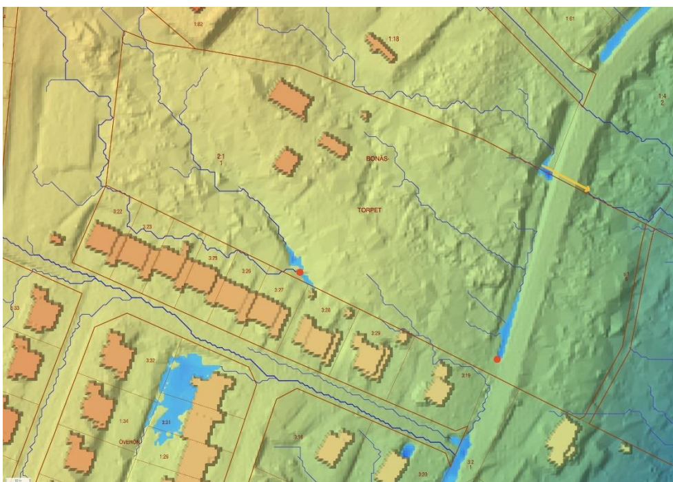
Figur 3. Befintlig avvattning av planområdet (Scalco live, 2024). Gul linje utgör befintlig trumma under Bonäsvägen som ej får nyttjas för avledning av dagvatten från planområdet. Orange prickar utgör brunnar som avleder dagvatten till ledningsnätet. Blå linjer utgör rinnstråk för vatten och tunna röda linjer utgör fastighetsgränser.
