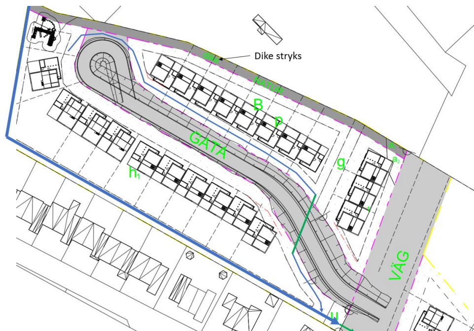
Figur 6. Föreslagen dagvattenhantering. Blå linjer utgör diken och grön linje/pil föreslagna nya trummor.
