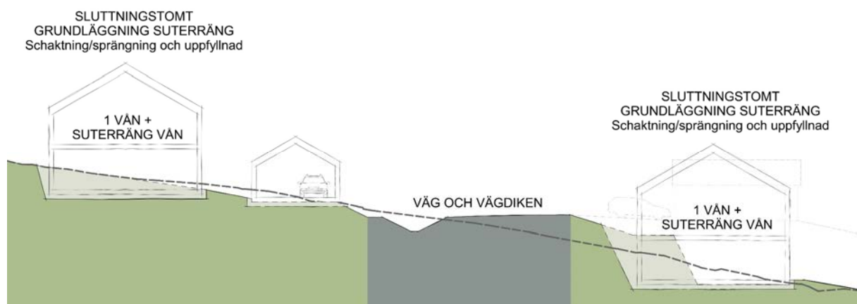
Figur 39. Principsektion tagen genom planområdets terräng och fastigheter. Detta är exempel på hur byggrätter kan utnyttas och hur huvudbyggnader och garage kan placeras på fastigheten. Principer för placering av byggnader i terrängen på sluttningstomter framgår.
