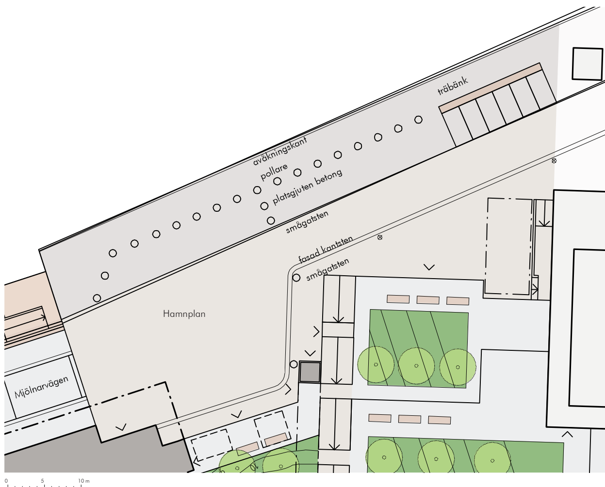
Illustration: Hamnplans utformning är lika övriga kajplaner med en stensatt inre del och en yttre betongkaj.
