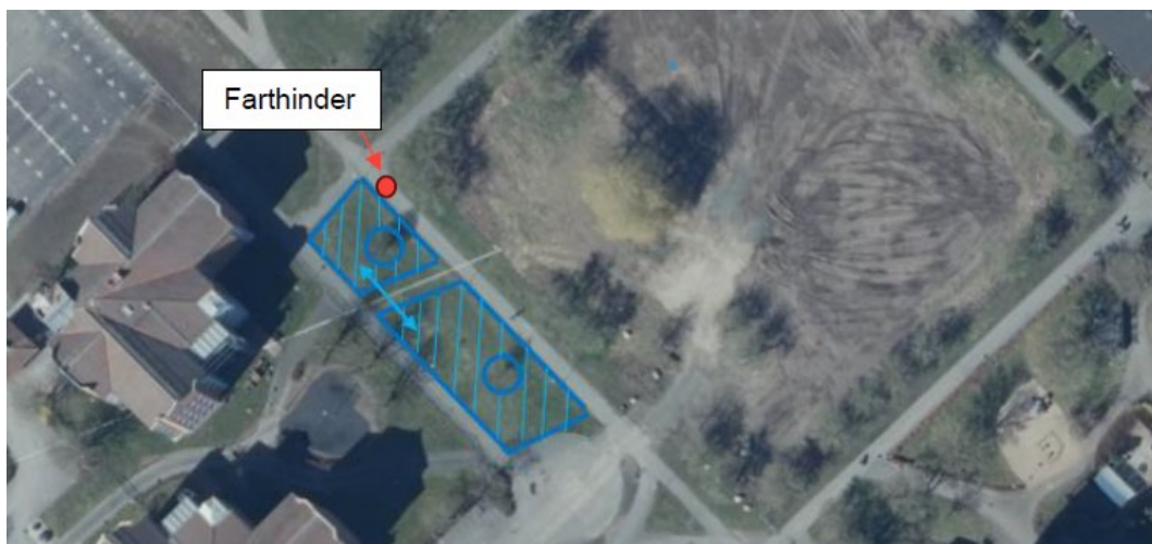
Förslag på placering av en försänkning för att hantera dagvatten och skyfall. Karta: WSP (WSP, 2023-12-15/2024-06-20)
