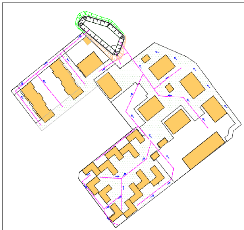
Dagvattenhantering inom planområdet, blåa pilar visar vattnets väg i dagvattensystem mot planerat dagvattenmagasin. Källa: TerrVia, PM Principskiss dagvattenlösning, 2022-07-07.
