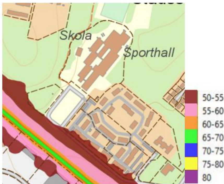
Figur 8. Buller från Bergslagsvägen. Ekvivalent ljudnivå. Bullerkarteringen visar på en prognostiserad trafikmängd för år 2040.
