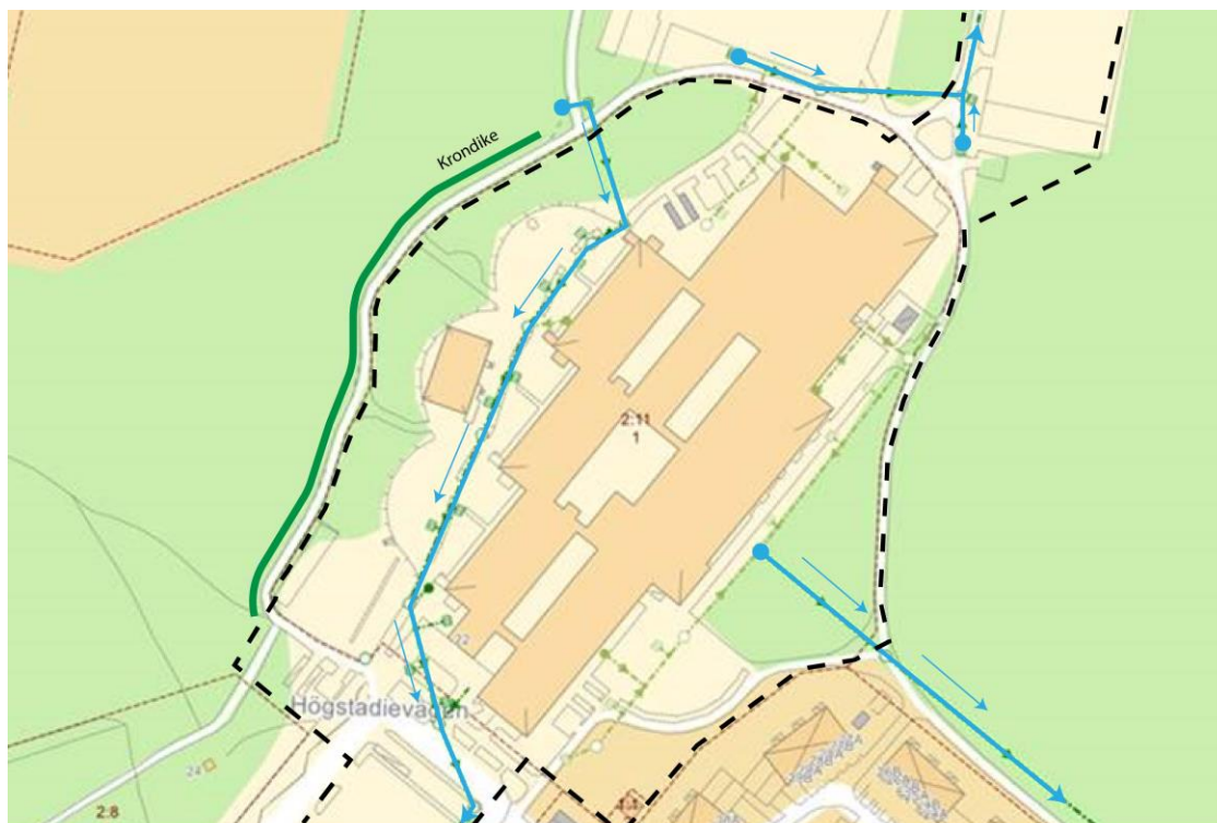
Figur 10. Dagvattenledningar inom planområdet dimensionerade för 10-årsregn.
