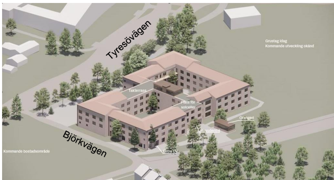
Figur 4-2. Illustration i 3D av planerad byggnad. Sadeltak leder dagvatten både in mot gårdarna och ut mot fastighetsgräns. Terrassytan kan avledas bort från innergårdarna. Bilden visar takutformningen, övrig gestaltning är ej uppdaterad i enlighet med granskningsförslaget.
