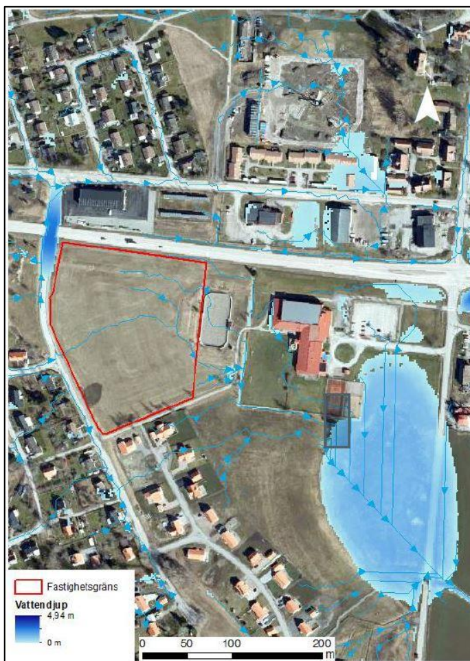
Riskområden för stående vatten motsvarande 100-års regn med klimatfaktor 1,25 (67,5mm). (Källa: Sweco).
