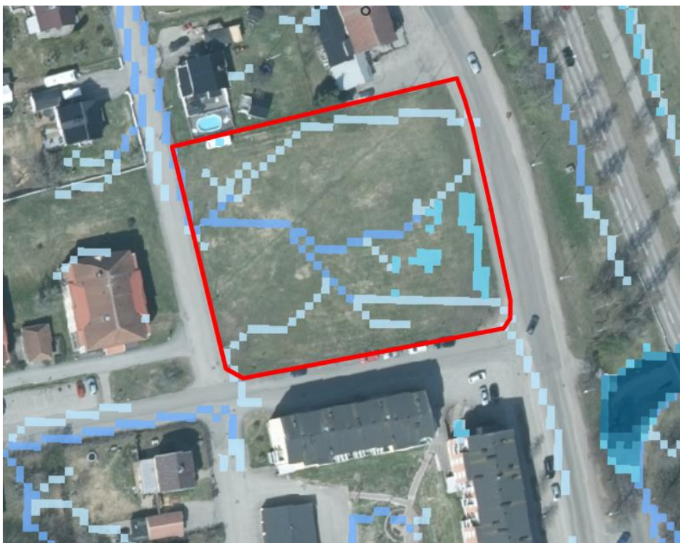
Figur 10: Rinnvägar och lågpunktskartering. Vattnet rinner åt det håll färgen blir mörkare. Planområdet visas inom röd linje.
