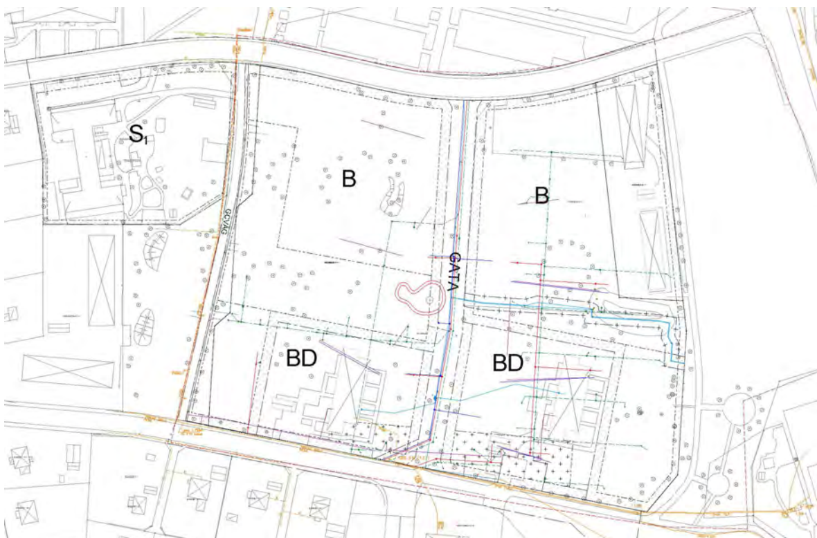
Figur 15, Planområdet med befintlig ledningsdragning.
