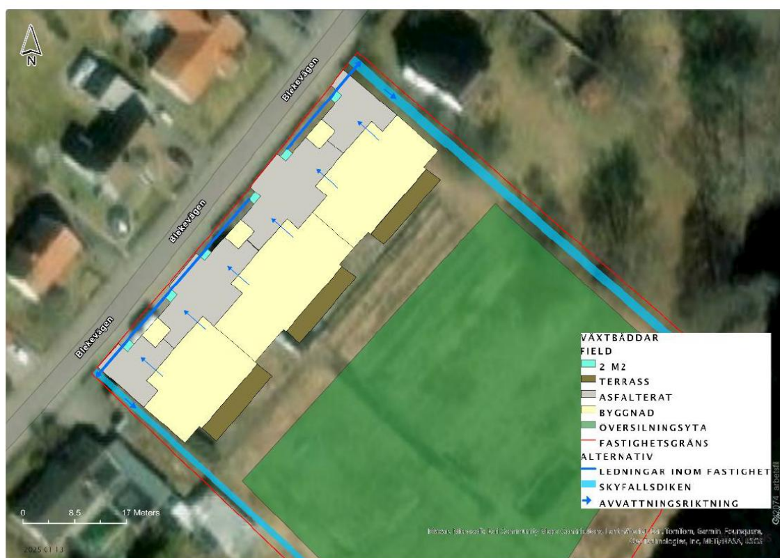
Figur 29. Alternativ 2 med ledningar inom fastighetens framsida
