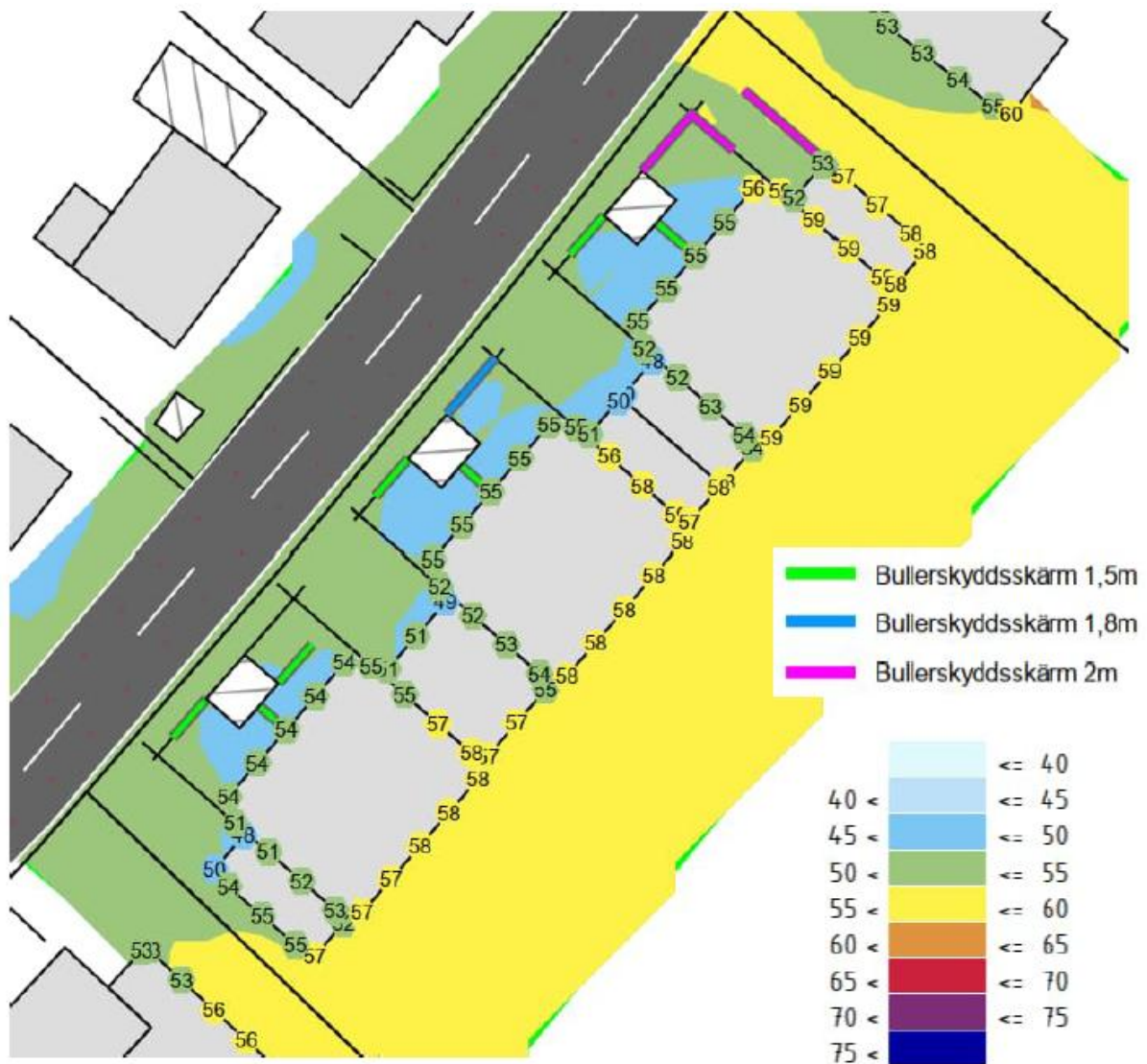
Figur 36. Lokala bullerskyddsskärmar i olika placeringar (Tyréns 2024)
