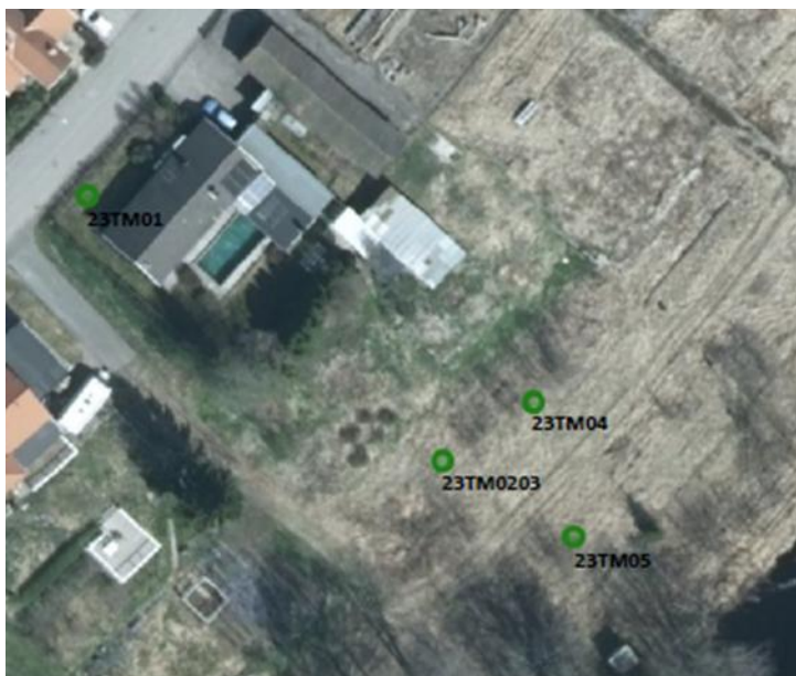
Figur 40. Provpunkterna 23TM01, 23TM203, 23TM04 och 23TM05 har analyserats beträffande organiska kolväten och metaller, samt att ett samlingsprov mellan provpunkt 23TM0203-23TM04 och ett enskilt prov i provpunkt 23TM05 även har analyserats avseende bekämpningsmedel.
