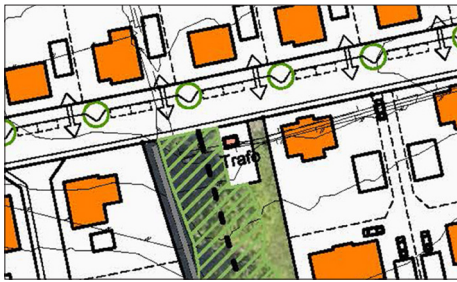
Föreslaget läge för transformatorstation och NOD-station.
