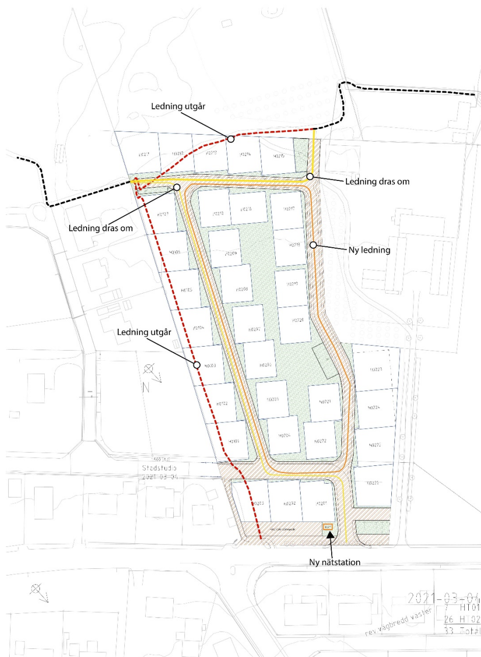
Illustration som visar befintlig och ny ledningsdragning el samt nätstation
