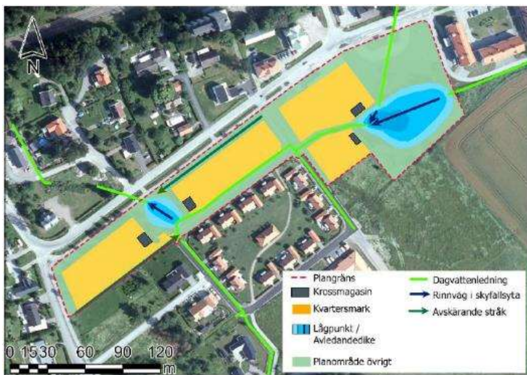
Figur 28. Föreslagen systemlösning för dagvattenhanteringen inom området.
