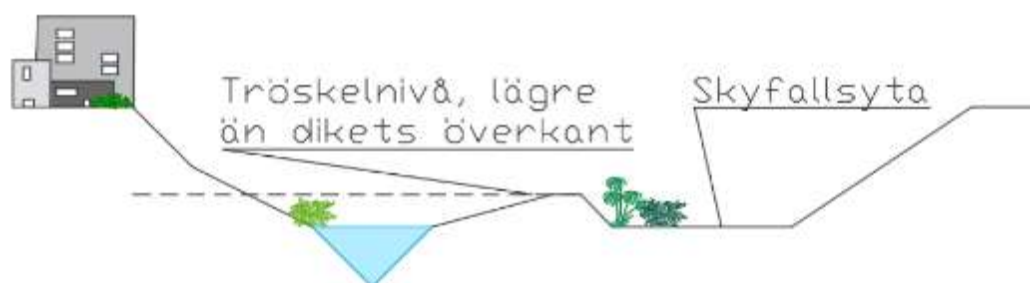
Figur 29. Principskiss över skyfallsytans utformning.
