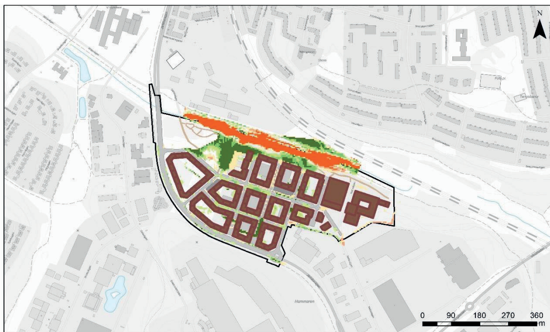
Skillnad i översvämningsdjup mellan nuläge och framtida utformning vid klimatanpassat 100-årsregn
