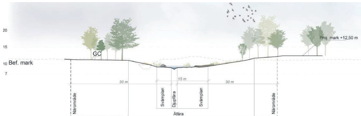
Sektion över ny utformning av Ballstaån med svämplan för att kunna hantera stora vattenmängder i området.
