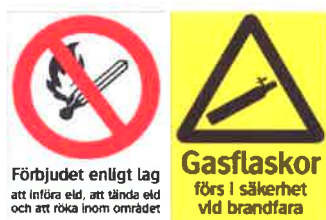
Figur 1. Exempel på anslag där gasflaskor med brandfarligt innehåll hanteras
