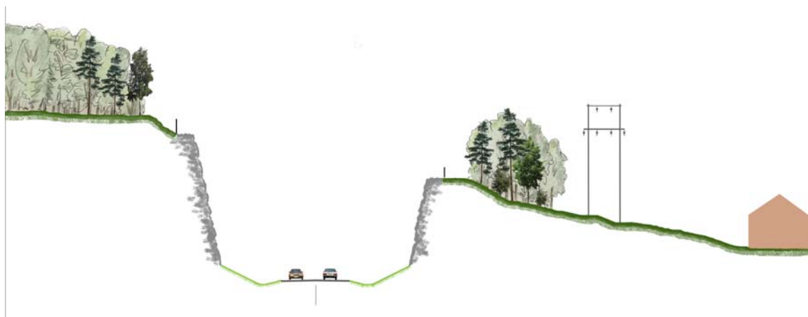
Illustration. Vägsektion vid omfattande bergskärning (Vägverket Konsult)
