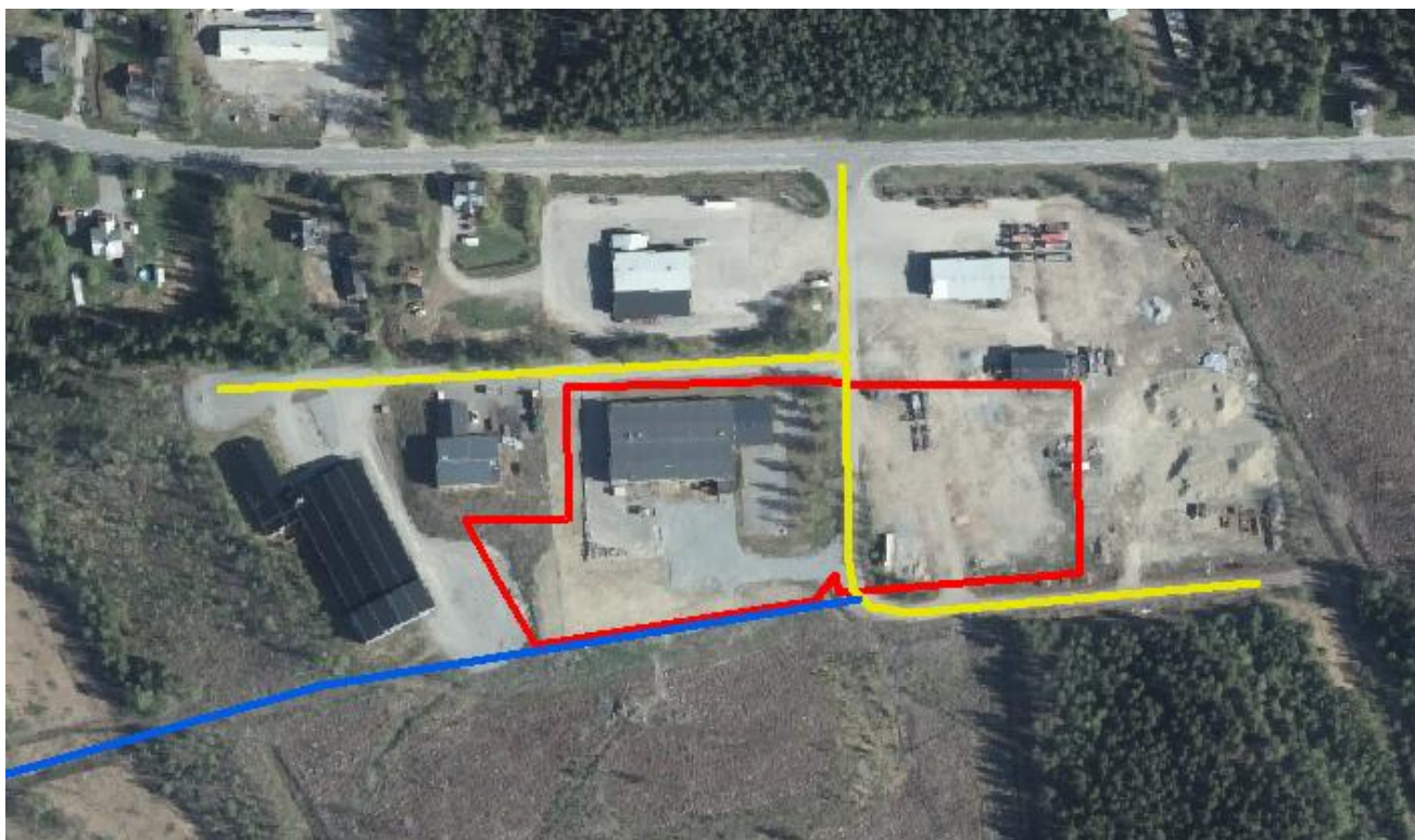
Figur 5: Röd markering visar föreslaget planområde, gul markering visar befintligt vägnät och blå markering visar planerad väg och GC-väg.
